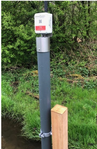
Fem målestationer følger vandstanden i og ved Bolbro Rende i et år.
