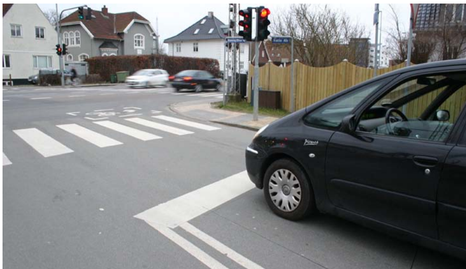
Bilister, der skal ud fra Dronning Olgas Vej, aktiverer grønt ved at holde helt henne ved stopstregen. De magnetiske følere skimtes her under bilens venstre forhjul.
