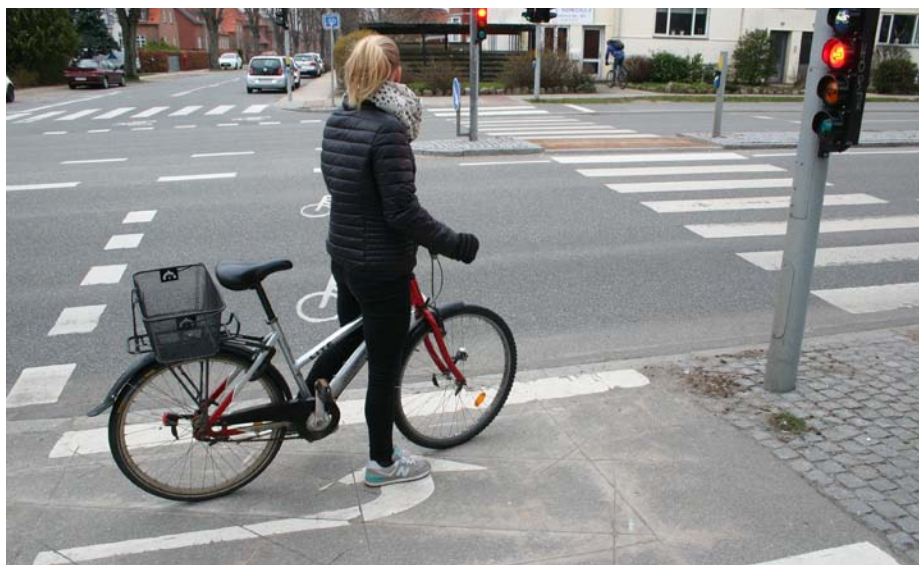
Cyklister, der kører ad Rugårdsvej ind mod byen, og skal til venstre ad Prinsesse Maries Allé, kan placere sig på pilen. Lige under ligger den føler, der aktiverer grønt.
